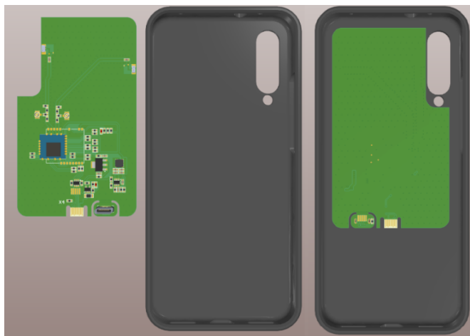
рис.1. – Печатная плата устройства и способ его монтирования в чехол смартфона
