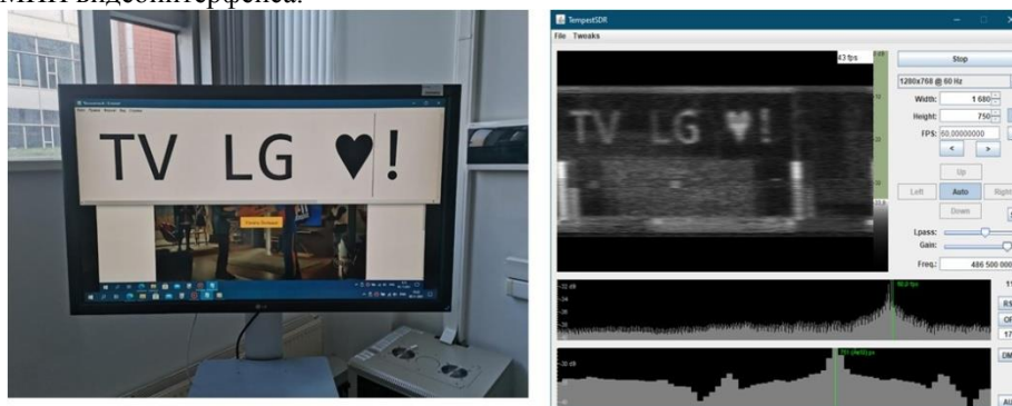
рис.1. Восстановление изображения подключённой по HDMI палении LG через гипсокартонную стену
