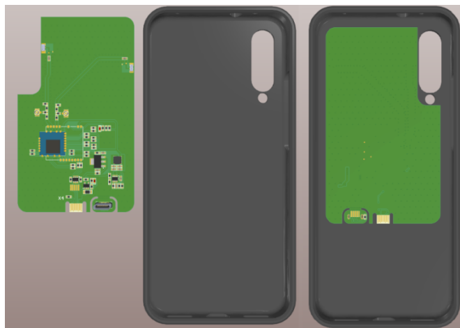
рис.1. – Печатная плата устройства и способ его монтажа в чехол смартфона
