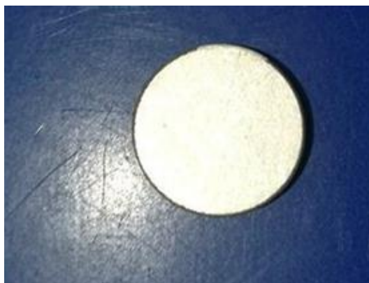
рис.1 Пьезоэлектрический керамический диск pzt-5h
